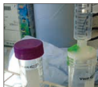
3. 用胶带将过滤器固定在 50 mL 收集管的顶部。
