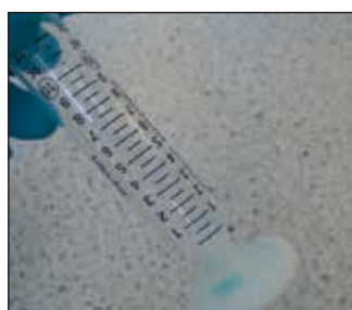
2. 取一个 10 mL 注射器,拔出注射器柱塞,然后将注射器连在过滤器进口。
