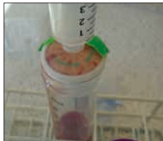
5. 过滤血样后,在针筒中加入 10 mL PBS 溶液,使溶液在重力作用下流过滤膜。
