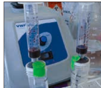
4. 将全血样本倒入针筒,使样本在重力作用下流过滤膜。
