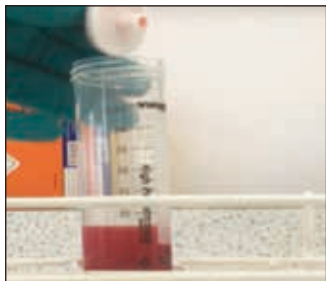
6. 收集管收集到的滤液是已滤除白细胞的样本。
